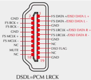
注: 在使用I<sup>2</sup>S接口播放DSD音频时, 如果发现左右声道不正确, 则可以使用这个选项来纠正。
