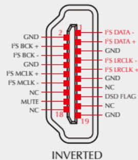
注: 这个选项用于匹配不同的I2S接口标准, 使用前请检查信号源的接口定义.
