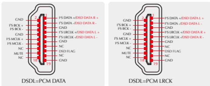
注: 在使用I<sup>2</sup>S接口播放DSD音频时, 如果发现左右声道不正确, 则可以使用这个选项来纠正。
