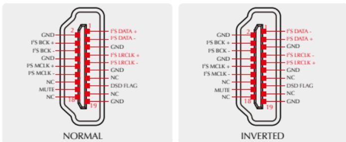
注: 这个选项用于匹配不同的I2S接口标准, 使用前请检查信号源的接口定义。
